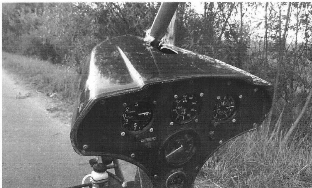
Фото 2. Повреждение обшивки обтекателя приборов
